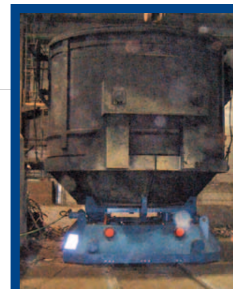
Carro porta cesta rottame con celle di pesatura portata 100 Ton.
