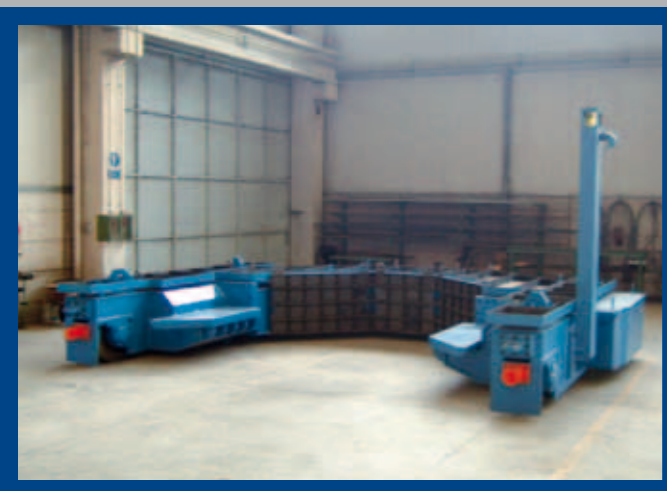
Carro porta siviera "open" per forno siviera portata 150 ton.
