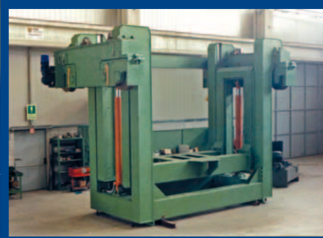
Carro porta siviera per fonderia con sollevamento idraulico e celle di pesatura, portata 50 ton.
